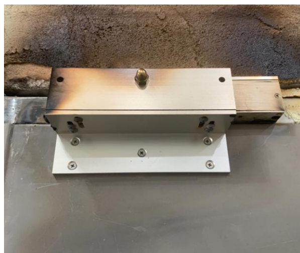
ELECTROMAGNETIC LOCK 시험 후
